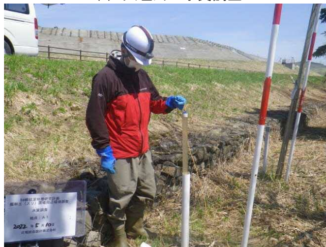
(b) 掘削土（ズリ）置場周辺での水質調査
